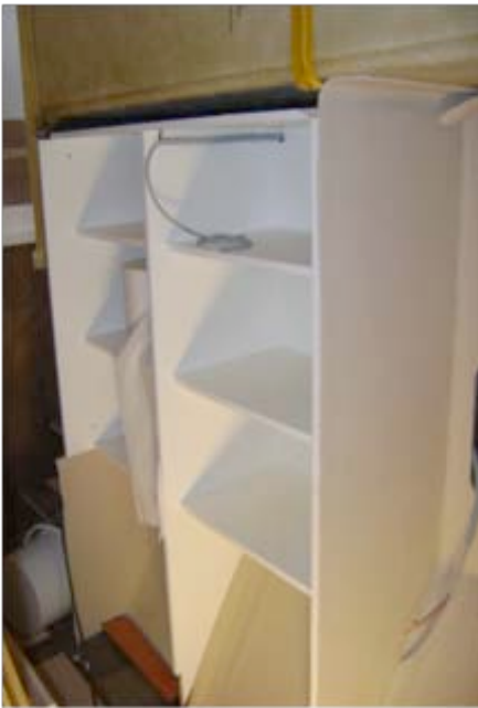
Dieses Regal verstärkt die Verbindung zwischen Rumpf und Cockpit
